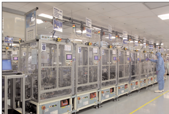
Потоковая сборочная линия картриджей
