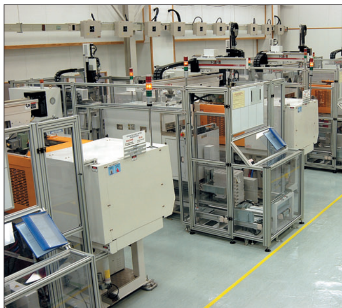
Автоматизированные комплексы создают пластиковые заготовки будущих картриджей
